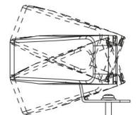
Horizont. Ausrichtung des Blitzmodul möglich
