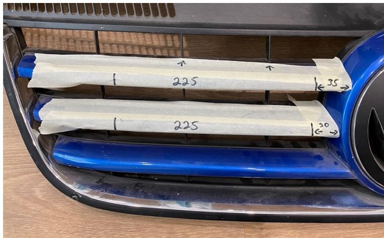
Der schnitt muss entlang der Markierung ausgeführt werden.
