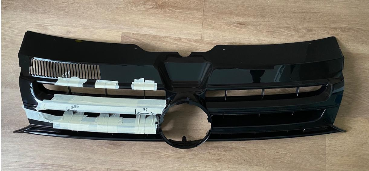
Der schnitt muss entlang der Markierung ausgeführt werden.
