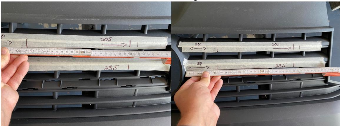
Der schnitt muss entlang der Markierung ausgeführt werden.
