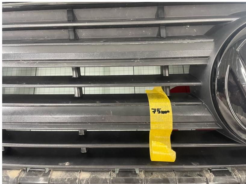
Von der 75mm Markierung werden 205mm für den Scheinwerfer und 8-10mm für die Halter. Also 215mm abgemessen Siehe Bild 2
