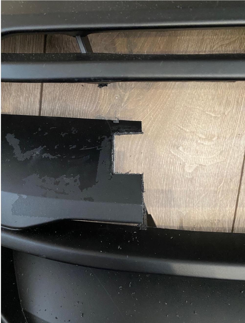
Die Kanten müssen sehr gut entgratet werden damit die Halter ohne Spannung aufgeschoben werden können.
