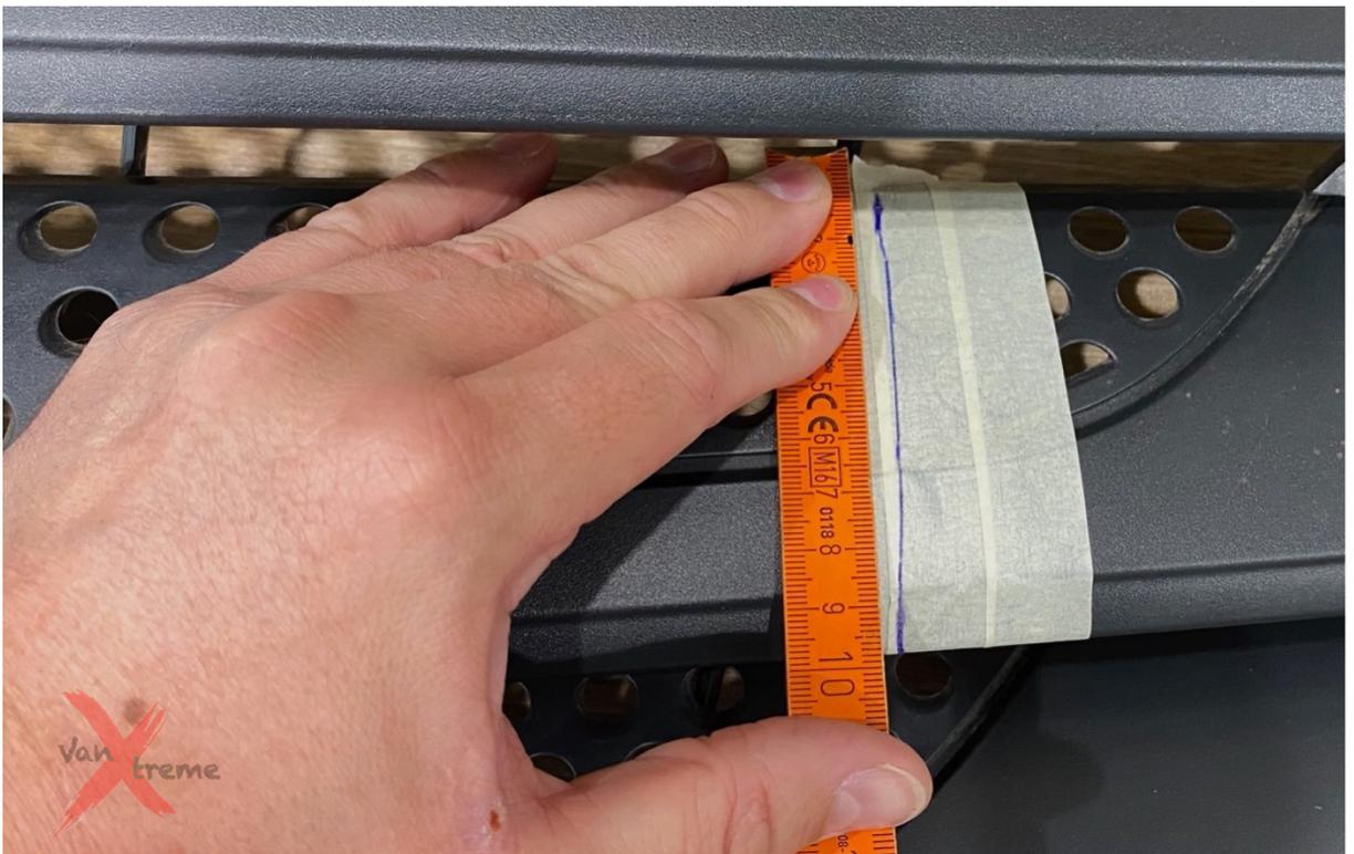
Der schnitt muss entlang dieser Linie ausgeführt werden.
