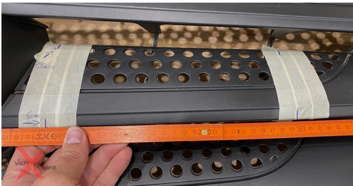
Am Kühlergrill wird in der Mitte oben am Stern angefangen zu Messen:
