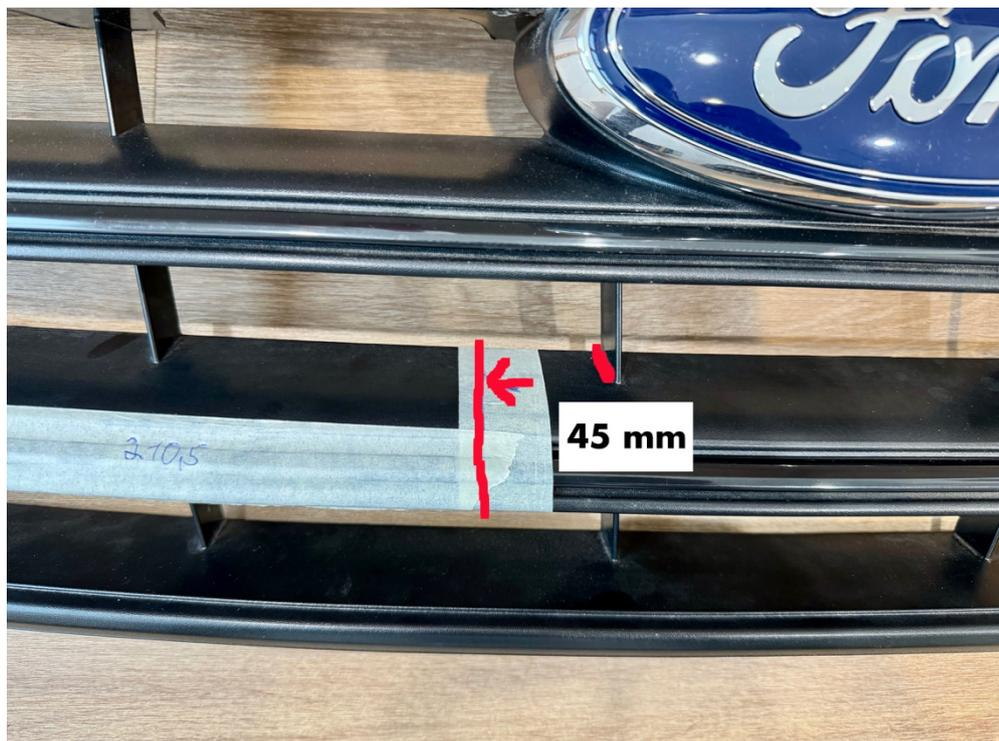
Von der 45mm Markierung werden 215mm für den Scheinwerfer und Halter abgemessen. Siehe Bild 2
